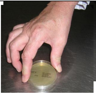
Etape 4 : Appliquer la gélose, sur la surface préparée et maintenir pendant 10 secondes sans bouger. Refermer avec précaution
